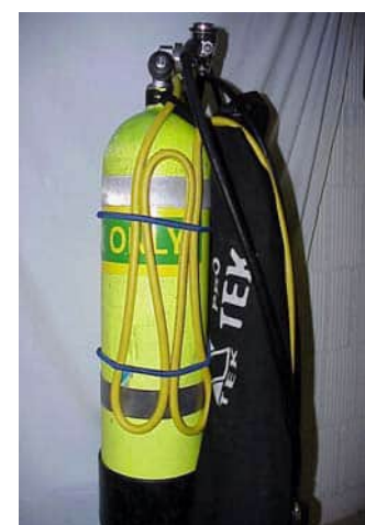
Langschlauch mit Befestigung; Mono-Gerät für Cavern-Bereich
